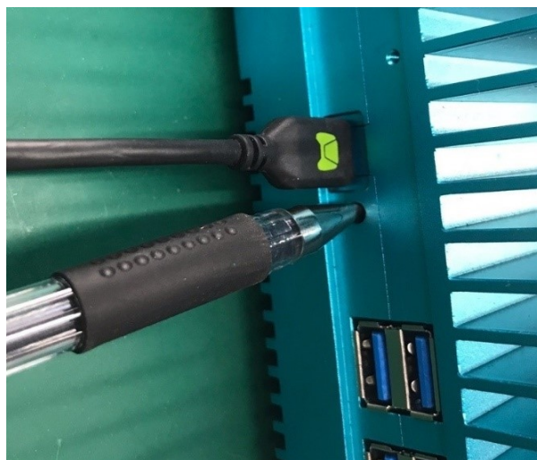
图 2 电脑与控制器的连接及隐藏按钮示意图
